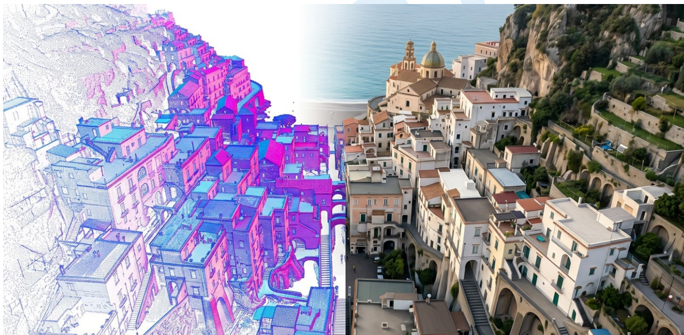
Fig 3. Confronto ontologico. A sinistra: Nuvola di punti da fotogrammetria aerea. A destra: Sintesi generativa text-to-image (verosimiglianza sintetica).
