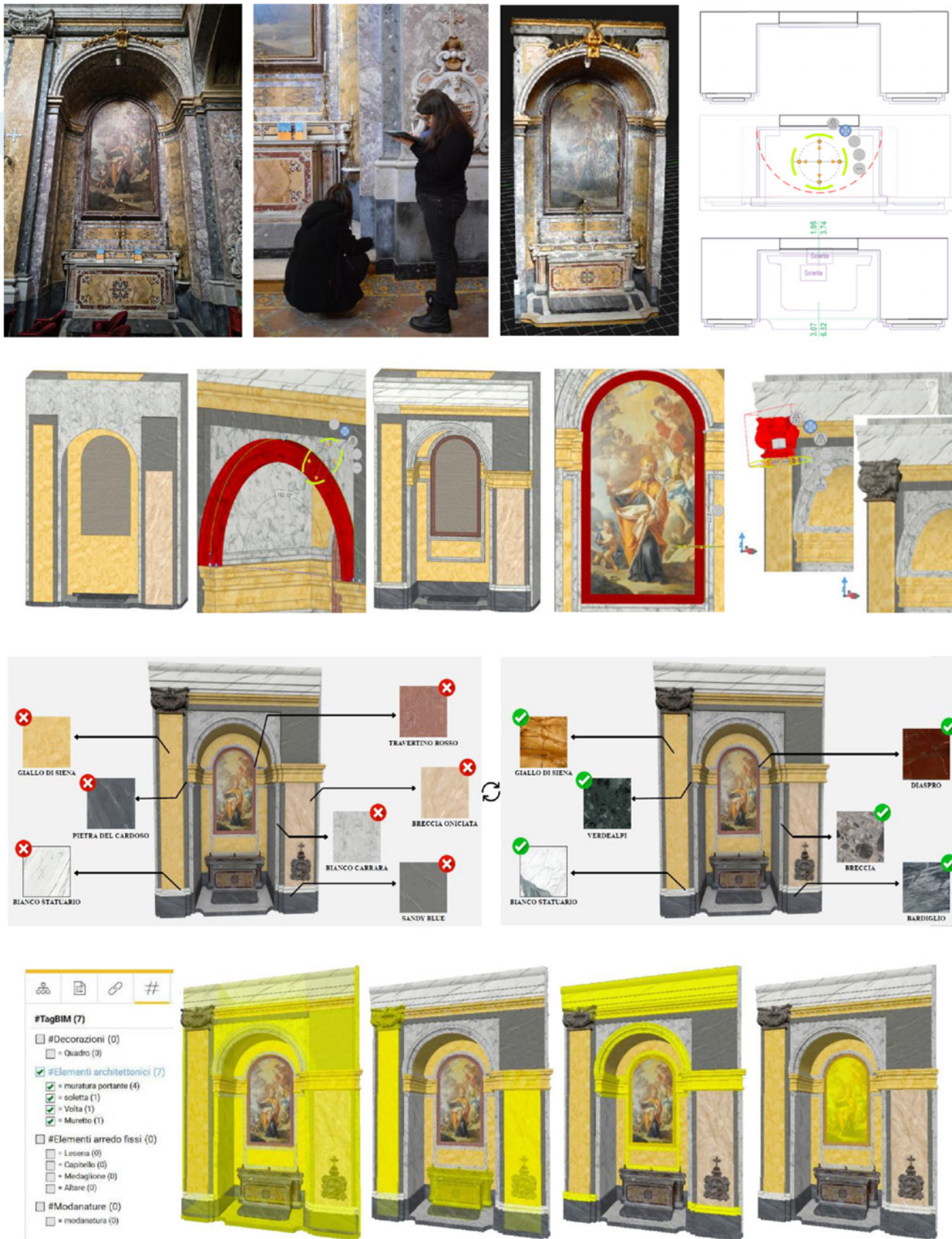
Fig. 4. Modellazione Cloud-to-HBIM di una cappella tipo (i.e. prima cappella a destra, ospitante il dipinto Sant'Agostino di Francesco De Mura); verifica e integrazione delle texture dei materiali lapidei; importazione in piattaforma e scomposizione semantica del modello. (Figura in versione preprint).
