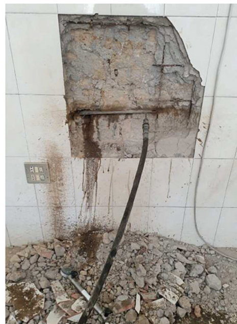
Fig. 6: INGEO, applicazione della prova con i martinetti piatti negli ambienti della Farmacia Storica.
