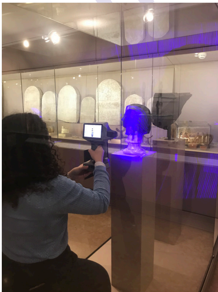
Fig. 3. Costruzione del database morfometrico tridimensionale. La fase di digitalizzazione dei reperti ha fatto ricorso al laser Shining3D Libre per la generazione di gemelli digitali ad alta fedeltà destinati al back-end analitico. Il dataset permette di mappare parametri diagnostici e soglie di stress cumulativo sulle topologie dei reperti, rendendo il rischio visibile e tracciabile.
