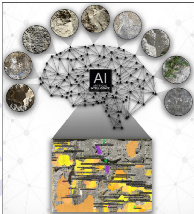
FIG. 1: Mappatura automatica delle forme di deterioramento su superfici lapidee mediante deep learning (Mask RCNN). Le alterazioni sono classificate e localizzate a supporto della diagnosi e del monitoraggio predittivo (da Hatir et al., 2021).
