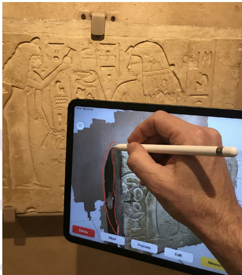
FIG. 1. Progetto MAPS, campagna di rilievo presso il Museo Civico Archeologico di Bologna. Integrazione tra diagnostica speditiva e gemello digitale: fase di annotazione semantica dello stato di fatto e mappatura dei degradi su tablet, finalizzata alla definizione di soglie computabili per la conservazione predittiva.
