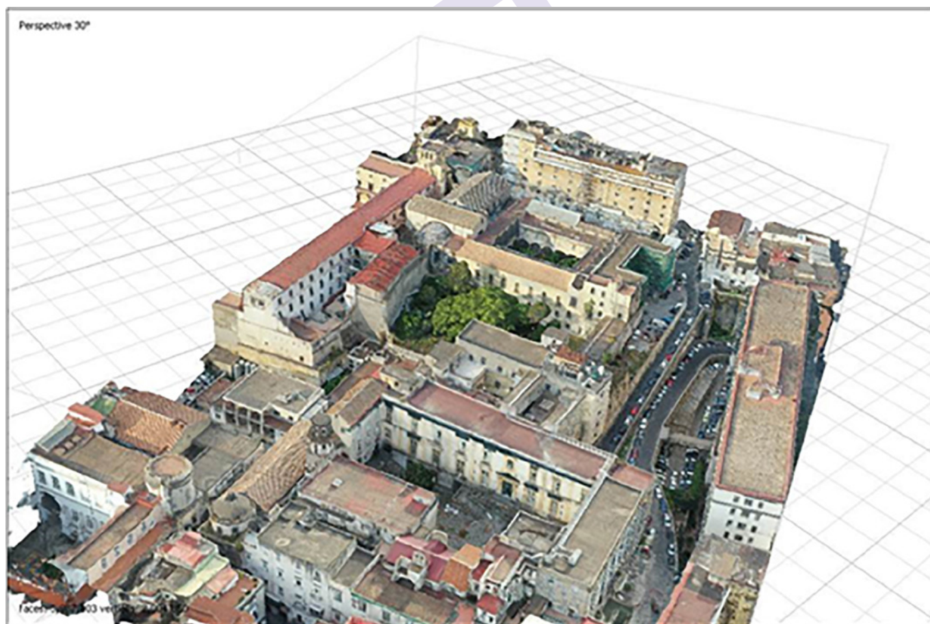
Fig. 1. Studio Associato Carafa e Guadagno. Mesh 3d del complesso dell’ex ospedale degli Incurabili dall’unione di nuvole di punti generate delle riprese dal drone e scansioni laser da terra.
