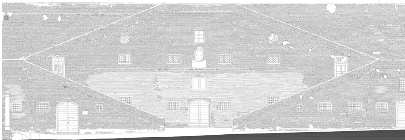
Fig. 2. Estratto del rilievo dello stato di fatto in corrispondenza dello scalone monumentale. Il primo registro della muratura a scarpa evidenzia la presenza diffusa di un biofilm da biodeterioramento nella porzione centrale. La proliferazione di biofilm algali ha comportato la comparsa di una caratteristica patina grigiastrea, tipica delle condizioni ambientali umide e moderate, con funghi, licheni crostosi e piante di capperi, fortemente ancorati ai giunti di malta e caratterizzati da numerosi rami lignificati.
