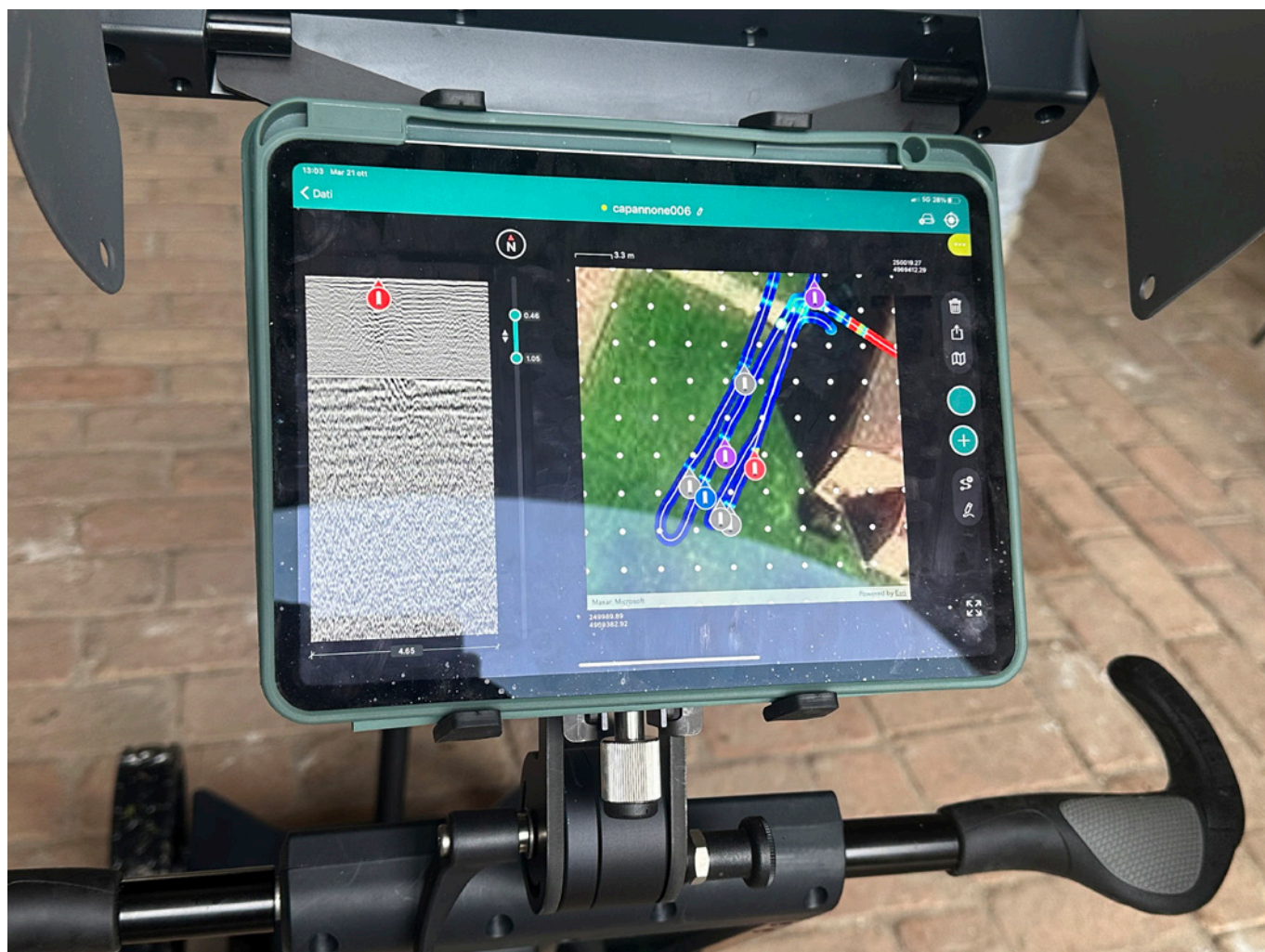
Fig. 5. Fase di acquisizione dei radargrammi finalizzata alla localizzazione dell'area di sedime di un corpo di fabbrica posto a chiusura della corte precedentemente demolito e alla verifica delle ipotesi causali per la definizione degli interventi mirati mediante evidenze co-registrate sulla base metrica del rilievo.
