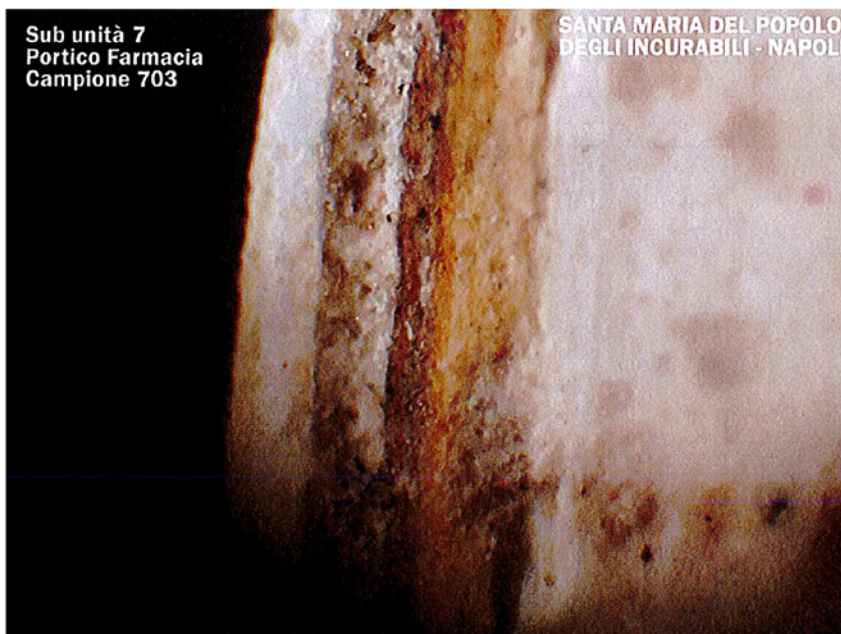
Fig. 5: BLUECAPRI, Farmacia Storica, parete interna del portico, particolare del campione ove emergono gli strati composti dai seguenti materiali: muratura in tufo giallo, intonaco con malta di calce, intonachino, strati di scialbature, strato di colore bruno, pittura colore giallo acrilico – vinilico.
