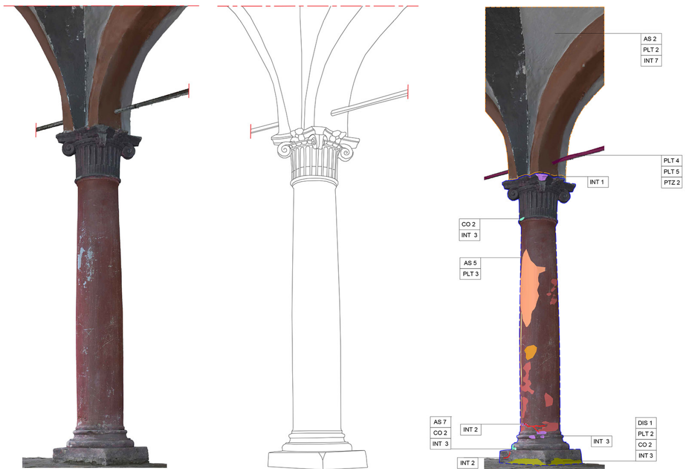
Fig. 4. Esempificazione del processo di classificazione delle aree di intervento su sistema informativo 3D, costruito a partire da acquisizioni ad alta risoluzione mediante laser scanner integrate con processo fotogrammetrico. La modellazione costituisce l'infrastruttura su cui si innestano livelli semantici e diagnostici co-registrati, consentendo di tradurre evidenze e indicatori in scelte operative tracciabili secondo una logica data decision-ready.
