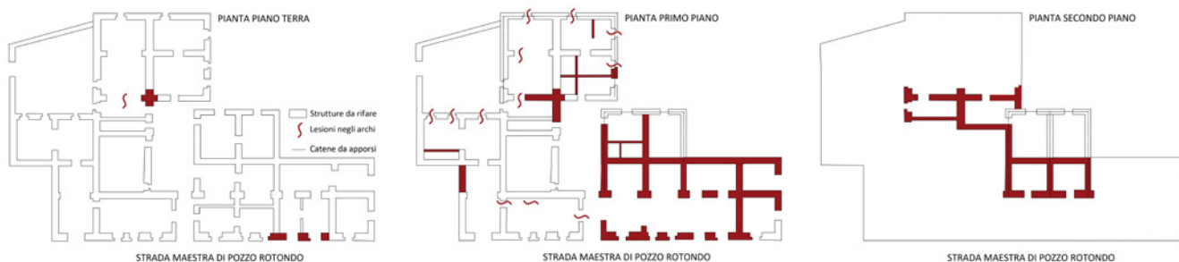
Fig. 4. Foggia, Palazzo Doganale. Rappresentazione planimetrica dei danni riportati dalla fabbrica secondo quanto descritto dall'ingegnere Tagliacozzi Canale, 1731. Foggia, Archivio di Stato, Dogana delle pecore. Inv. V, B. 52, f.lo 4544, rielaborazione a cura dell'autrice.
