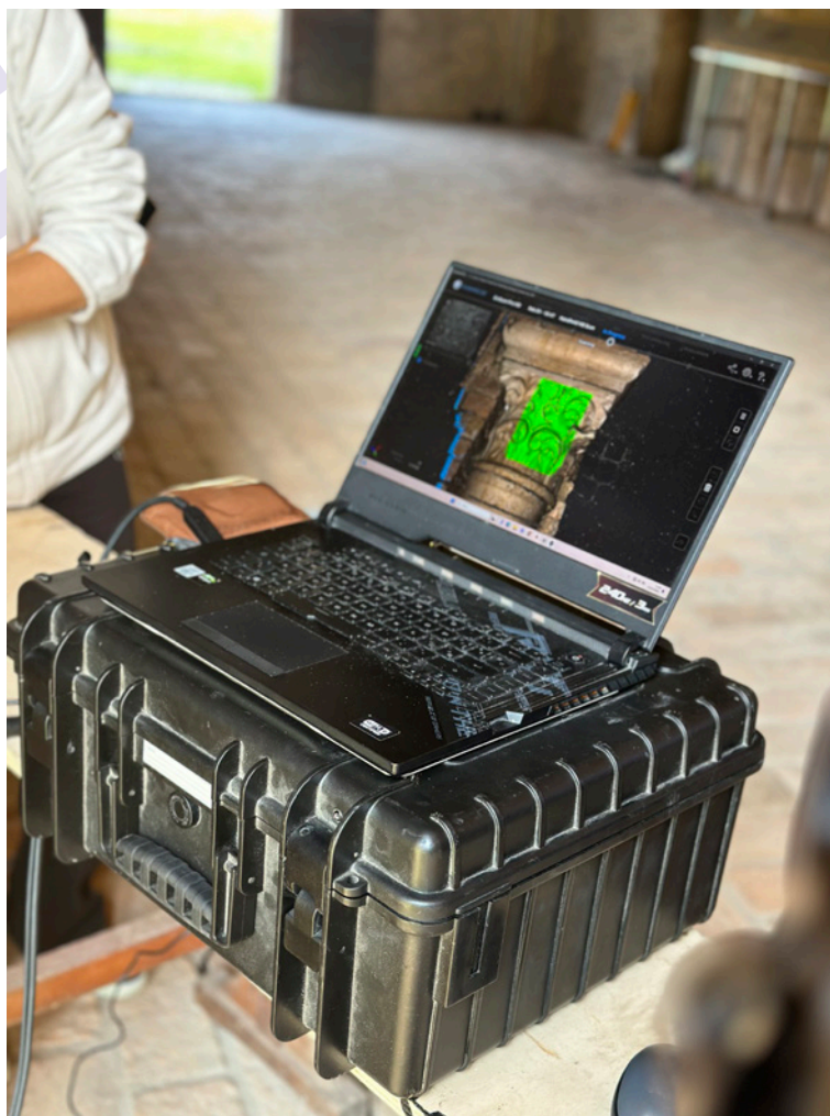
Fig. 3. Acquisizione ad alta risoluzione del dato morfometrico tridimensionale mediante laser scanner a luce strutturata (Shining3D Einscan ProHD).
