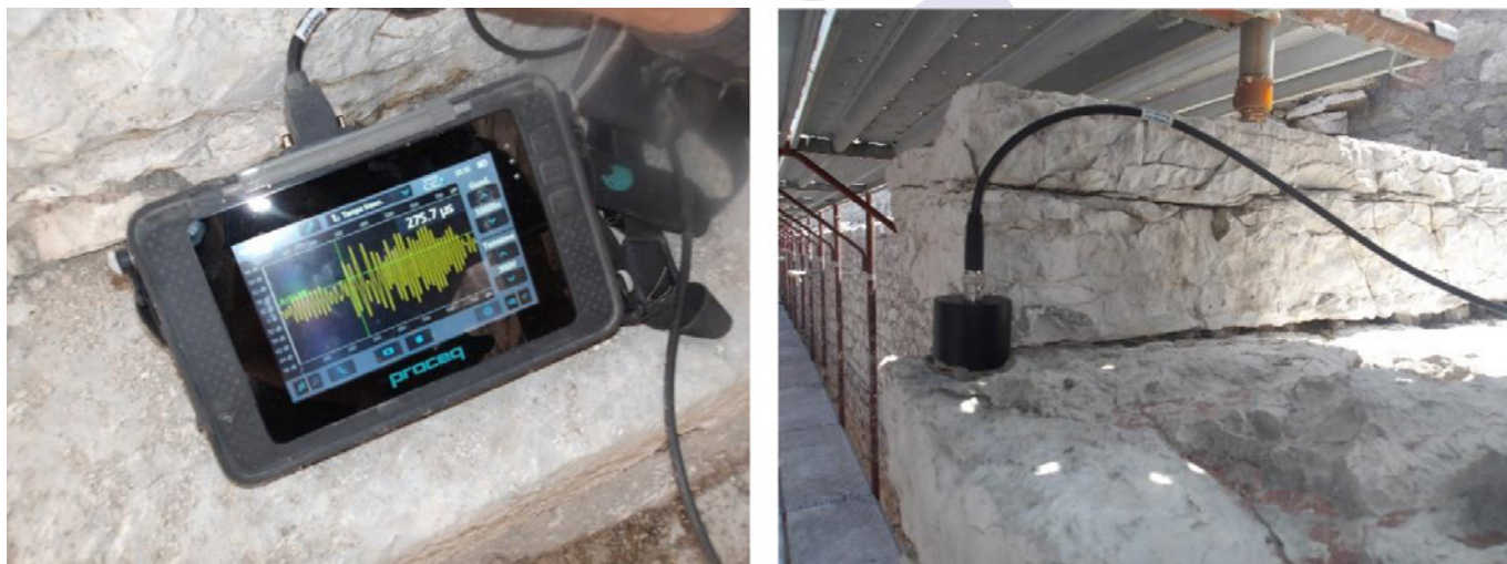
Fig. 2: Trento, Mura di Piazza Fiera, indagini soniche in corrispondenza degli scalini in pietra, ALTRAINGEGNERIA s.r.l.
